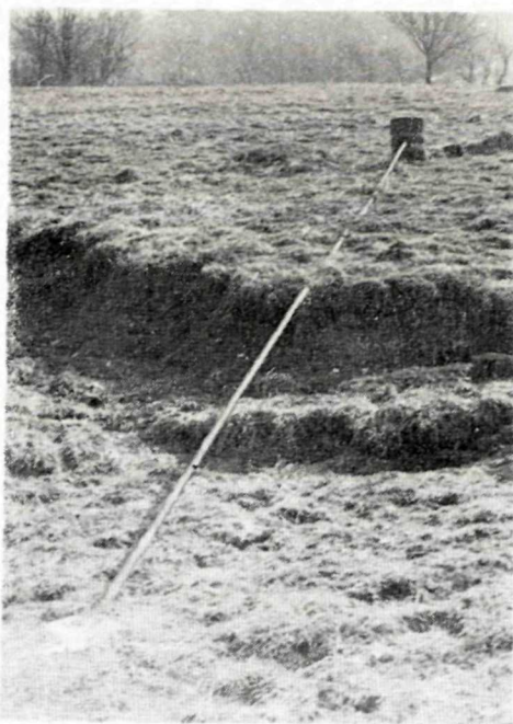
Obr. 3. Osadený jednoduchý — dvojbodový mechanický lankový extenzometer MMP-120 v odlučnej zóne zosuvu Mostište
